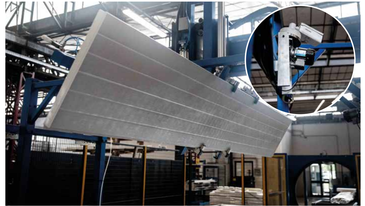
Sistema di controllo automatizzato. Verifica incrociata dell'estetica dei pannelli e sistema di archiviazione di ogni porta. Automated control system. Cross-checking of panel aesthetics and filing system for each door.
