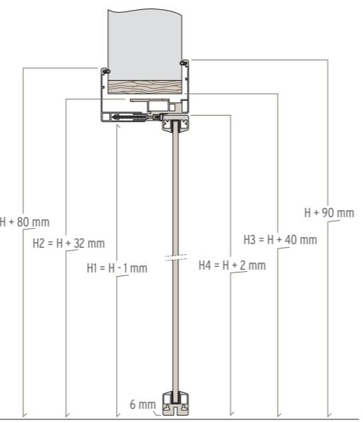
**Profilo con pannello.** profile with panel. profil avec panneau. perfil con panel. Profil mit Türblatt. профиль с панелью.
