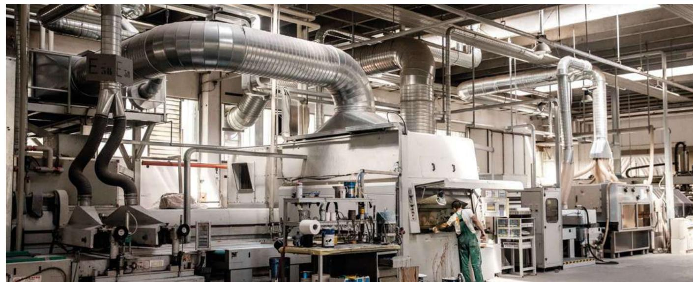
Doppia linea di verniciatura con forno a infrarossi con sette trattamenti sui pannelli Silvelox per completare la reticolazione della vernice.
